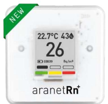
Découvrez Aranet Radon Plus, un appareil conçu pour mesurer en continu les niveaux de radon, un gaz inodore et nocif pour la santé. Il mesure aussi la température, l'humidité et la pression atmosphérique. Compact et sans fil, il s'installe facilement dans divers environnements !
